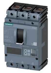
Leistungsschalter 3VA2 IEC Frame 100 Schaltvermögenklasse H Icu=85kA @ 415V 3-polig, Anlagenschutz ETU860, LSIG, In=25A Überlastschutz Ir=10A...25A Kurzschlussschutz Isd=0,6..10x In, li=1,5..12x In N-Leiterschutz optional mit externem Stromwandler, bis 160% Erdschlussschutz, abschaltbar Ig=0,2...1 x In, tg=0,05-0,8s Klemmenanschluss
