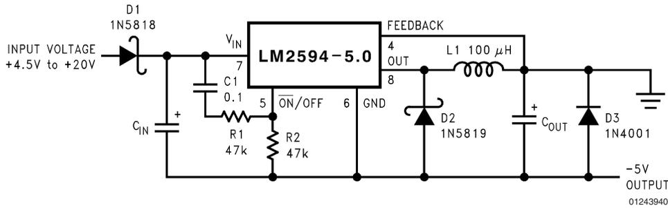
$C_{IN}$  — 68  $\mu\text{F}/25\text{V}$  Tant. Sprague 595D
