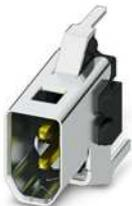
SPE-Leiterplatten-Steckverbinder, Bauform: IEC 63171-2, Schutzart: IP20, Polzahl: 2, 1 GBit/s, CAT B (ISO/IEC 63171), Material: Metall, Anschlussart: THR-Lötanschluss, Kabelabgang: gerade, Single Pair Ethernet
