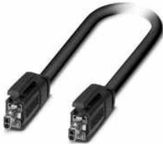
Patch-Kabel, Bauform: IEC 63171-2, Schutzart: IP20, Kabellänge: 3 m, Polzahl: 2, 1 GBit/s, CAT B, Material: TPU, Anschlussart: Crimpanschluss, Anschlussquerschnitt: AWG 22- 22, Kabelabgang: gerade, Single Pair Ethernet
