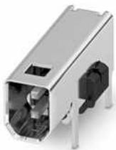
SPE-Leiterplatten-Steckverbinder, Bauform: IEC 63171-2, Schutzart: IP20, Polzahl: 2, 1 GBit/s, CAT B (ISO/IEC 63171), Material: Metall, Anschlussart: THR-Lötanschluss, Kabelabgang: gerade, Single Pair Ethernet
