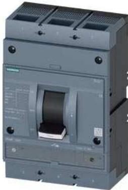
Leistungsschalter 3VA1 IEC Frame 1000 Schaltvermögenklasse H Icu=70kA @ 415V 3-polig, Anlagenschutz TM240, ATAM, In=800A Überlastschutz Ir=560A...800A Kurzschlusschutz Ii=5...10 x In Schraubenflachanschluss
