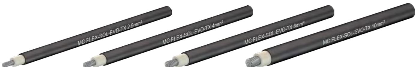
Halogenfreie, raucharme, flexible, einadrige, vernetzte doppellagige Photovoltaik-Leitungen, insbesondere für den Einsatz auf der Gleichstromseite (DC) von Photovoltaikanlagen. Diese Leitungen sind so konzipiert, dass sie für den Anschluss an die meisten PV-Komponenten nach Klasse II geeignet sind und haben eine Nennleichspannung von 1,5 kV (IEC) zwischen den Leitern sowie zwischen Leiter und Erde. Die maximal zulässige Betriebs-Gleichspannung beträgt 1,8 kV.
