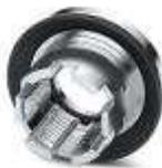
M12-Gewindehülse mit toleranzausgleichender Funktion, für gerade, SMD-fähige M12-Buchsenkontakteinsätze. Geeignet für Frontplattenwandstärken von 0,9 mm ... 1,6 mm.
