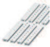
Zackband, Streifen, weiß, beschriftet, beschriftbar mit: Plotter, längs bedruckt: fortlaufende Zahlen 1-10, 11-20 usw. bis 491-500, Montageart: Verrasten in hoher Schildchennut, für Klemmenbreite: 8,2 mm, Schriftfeldgröße: 10,5 x 8,15 mm
