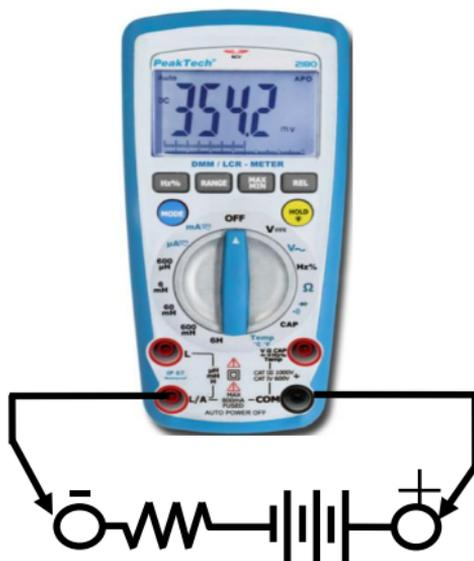
1. Messbereich mit dem Funktions-/ Bereichswahlschalter wählen. Bei unbekanntem Messwert aus Sicherheitsgründen in den höchsten Messbereich (mA) umschalten. Bei entsprechender Anzeige ggf. auf einen niedrigeren Messbereich umschalten.
