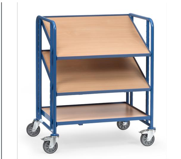
Stahlrohr und Profilstahl-Konstruktion, pulverbeschichtet RAL 5007. Schraubkonstruktion. Etagenrahmen mit Holzwerkstoffplatte, Oberfläche Buchendekor. Variabel einschraubbar, Raster 50 mm, Neigung bei schrägem Einbau 15° oder 30°. Tragkraft obere und mittlere Ladefläche 80 kg. 3 Holzwerkstoffplatten, Rand 13 mm hoch. 4 Lenkrollen, TPE-Bereifung, Naben mit Rillenkugellager. 2 Stück mit Feststeller, gemäß der Europäischen Norm EN 1757-3 (Sicherheit von Plattformwagen).
