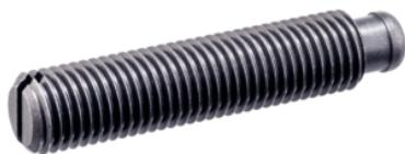
Les goujons filetés sont des vis de bridage qui peuvent transférer directement les forces via l'embout sphérique de pression. Dans la version en acier, la surface de pression de l'embout sphérique de pression est durcie.
