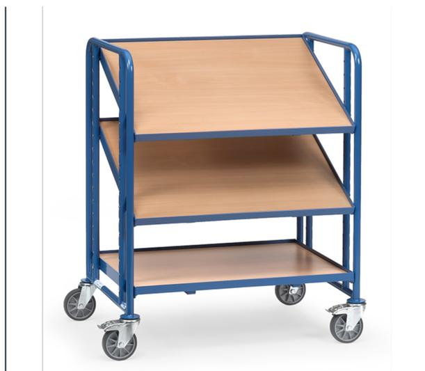
Ensemble mécano-soudé, revêtement époxy bleu RAL 5007. 3 plateaux amovibles avec mélaminé surface effet hêtre avec rebord de 13 mm. Plateaux réglables au pas de 50 mm et inclinables de 15° et 30°. 4 roues pivotantes à bandage TPE, moyeu à roulement à billes. 2 roues avec freins conformément à la Norme 1757-3 (Sécurité des chariots de manutention). Charge plateau haut et intermédiaire : 80 kg. Livré sans bacs
