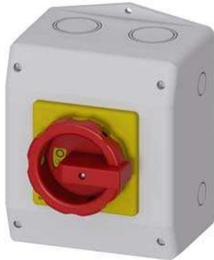
SENTRON, Lasttrennschalter 3LD, Not-Aus-Schalter, 4- polig, 63 A, Betriebsleistung bei AC-23 A bei 400V: 22 kW, Isolierstoff-Kapselung für metrische Verschraubung, Drehantrieb, rot/gelb
