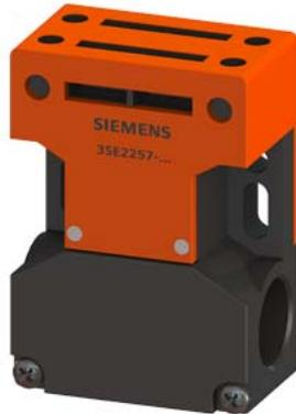
Sicherheits-Positionsschalter mit getrenntem Betätiger Formstoffgekapselt kurzes Gehäuse, 3x(M20x1,5) seitliche und stirnseitige Betätigung Schleichschaltglied 1 Ö, Auszugskraft 5 N Lieferung ohne Betätiger
