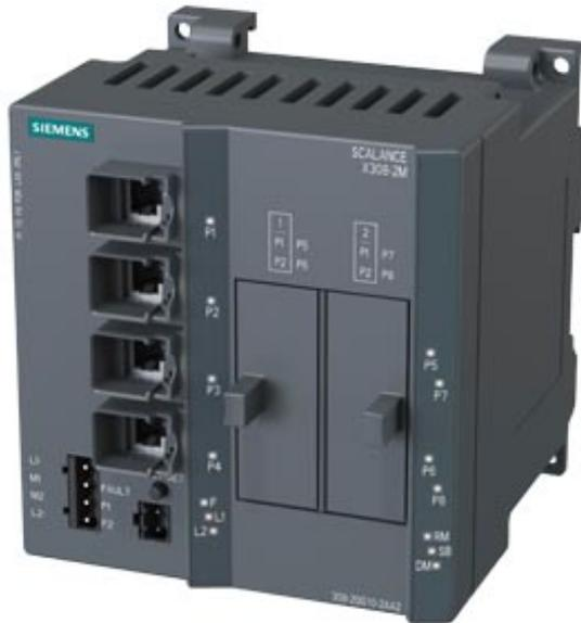
SCALANCE X308-2M; managed IE Switch, kompakt; 4x 10/100/1000 Mbit/s für RJ45 Ports elektrisch; 2x 100/1000 Mbit/s für 2-Port-Medienmodule, elektrisch oder optisch; LED-Diagnose; Fehlermelde- Kontakt; Select/Set-Taster; PROFINET IO Device; Netzwerk- Management; integrierter Redundanz-Manager; Office Features (RSTP, VLAN, IGMP,..); C-PLUG im Lieferumfang
