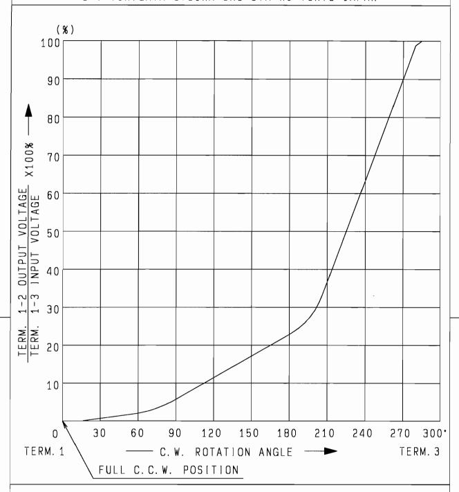
AT 150° C.W. SHAFT ROTATION FROM FULL C.C.W. POSITION VOLTAGE PERCENT SHALL FALL WITHIN THE LIMITS OF 10~25 PERCENT.
