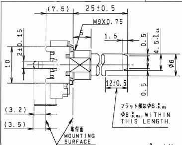
取付穴寸法図(公差±0.1) \*挿入側からみを図 P.W.B. MOUNTING DETAIL (TOLERANCE±0.1) VIEWED FROM MOUNTING SIDE
