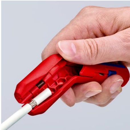
Dégainage d'un câble coaxial
