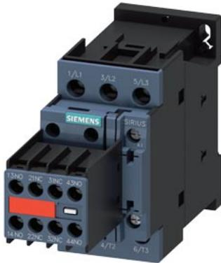
Leistungsschütz, AC-3e/AC-3, 32 A, 15 kW / 400 V, 3-polig, AC 230 V, 50/60 Hz, Hilfskontakte: 2 S + 2 Ö, Schraubanschluss, Baugröße: S0, Hilfsschalter unlösbar, kein Überspannungsbegrenzer nachrüstbar
