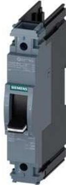
Leistungsschalter 3VA5 UL Frame 125 Schaltvermögenklasse S 25kA @ 277V 1-polig, Anlagenschutz TM210, FTFM, In=35A Überlastschutz Ir=35A fest eingestellt Kurzschlusschutz Ii=10 x In ohne Anschluss
