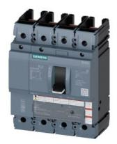
Leistungsschalter 3VA5 UL Frame 250 Schaltvermögenklasse M 35kA @ 480V 4-polig, Anlagenschutz TM210, FTFM, In=250A Überlastschutz Ir=250A fest eingestellt Kurzschlussschutz Ii=10 x In N-Leiterschutz 100% ohne Anschluss
