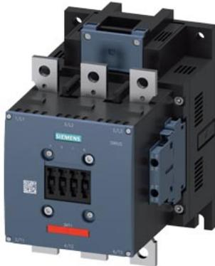
Leistungsschütz, AC-3 265 A, 132 kW / 400 V AC (50-60 Hz) / DC-Betätigung AC/DC 23-26 V Hilfskontakte 2 NO + 2 NC 3-polig, Baugröße S10 Schienenanschlüsse Antrieb: konventionell Schraubanschluss Hilfsschalterblock 2 S + 2 Ö seitlich, links + rechts Hilfsschalterblock unlösbar DIN 50012
