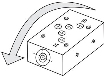
Pour ce qui est des embases empilables avec un seul trou T (TA ou TB), il faut veiller à ce que la connexion vers T ne soit pas interrompue, mais reste intacte.
