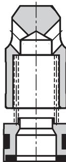
**Modèle "T"** (pression d'ouverture de 0,5 bar)
