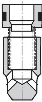
**Modèle "P"** (pression d'ouverture de 0,5 bar)
