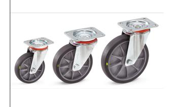
160 x 40 mm. Armature en tôle d'acier galvanisée. Roue à bandage TPE-ESD (Élastomère thermoplastique) conductrice d'électricité, moyeu à roulement à billes de précision. Bandage non traçant.
