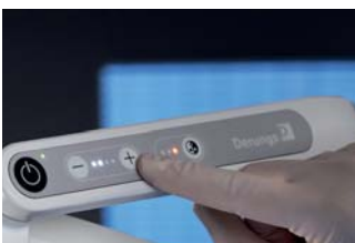
Intuitive Bedienung einfach und in Griffnähe über Folientastatur bedienbar
