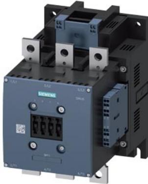
Leistungsschütz, AC-3e/AC-3 265 A, 132 kW / 400 V AC (50-60 Hz) / DC U<sub>c</sub>: 500-550 V 3-polig, Hilfskontakte 2 S + 2 Ö Antrieb: konventionell Hauptstr.: Schiene Steuer- und Hilfsstromkreis: Federzuganschluss
