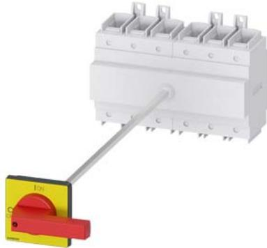
SENTRON, Lasttrennschalter 3LD, Not-Aus-Schalter, 6- polig,  $I_n=250A$ , Betriebsleistung / bei AC-23 A bei 400V: 132 kW, Bodenbefestigung mit Türkupplung, Knebelantrieb, rot/gelb, 4-Loch Befestigung der Handhabe
