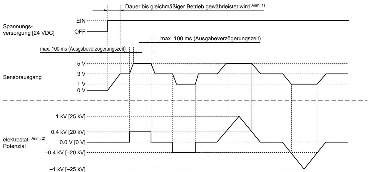
Anm 1) Der Sensor ist ca. eine Sekunde nach dem Einschalten betriebsbereit, aber die Anzeige weist möglicherweise noch Unregelmäßigkeiten auf. Daher wird empfohlen, den Sensor erst 10 Minuten nach Einschalten zu betreiben.
