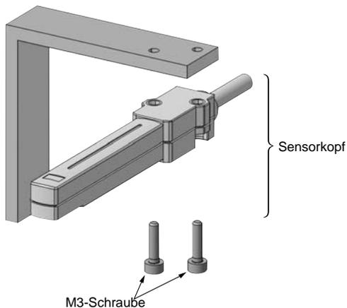
4. Bringen Sie die Schraubenköpfe an die Sitzoberfläche (s. Abbildung unten) an, um den Sensorkopf zu montieren. Werden die Schrauben bei der Montage von der Gegenseite aus angebracht, kann dies den Sensorkopf beschädigen.
