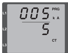
Abb. Programmier-Modus Stromwandler Über die Tasten 1 und 2 können Primär- und Sekundärstrom geändert werden (vgl. Seite 40).
