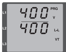
Abb. Programmier-Modus Spannungswandler Über die Tasten 1 und 2 können Primär- und Sekundärstrom geändert werden (vgl. Seite 41).
