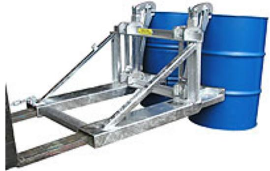
"RS" ist in drei verschiedenen Farben und zwei Traglasten erhältlich. Farbe: orange (RAL 2000), blau (RAL 5012) oder feuerverzinkt nach EN ISO 1461 Max. Gabelzinkenquerschnitt: 150 x 65 mm Typ "RS 1": für max. ein 200-Liter-Fass Traglast: 800 kg, Gabelabstand: 240 mm, Maße (B/T/H): 585 x 1290 x 930 mm, Gewicht: 94 kg
