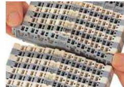
Klemme kräftig nach außen drücken und von der Tragschiene hebeln.
