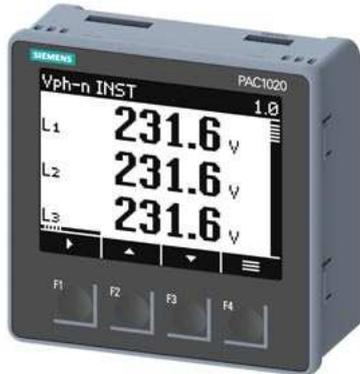
SETRON PAC1020 96X96 mm Power Monitoring Device Schalttafeleinbaugerät zur Messung elektrischer Größen Protokoll: Modbus RTU Mit grafischem Display UE Nenn max: 400/230V 45-65Hz IE Nenn: X/5A AC Hilfsenergie: 85V - 276V AC Schraubklemmenanschluss
