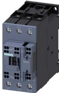
Leistungsschütz, AC-3 40 A, 18,5 kW / 400 V 1 S + 1 Ö, AC 110 V 50 Hz, 3-polig, Baugröße S2, Federzuganschluss
