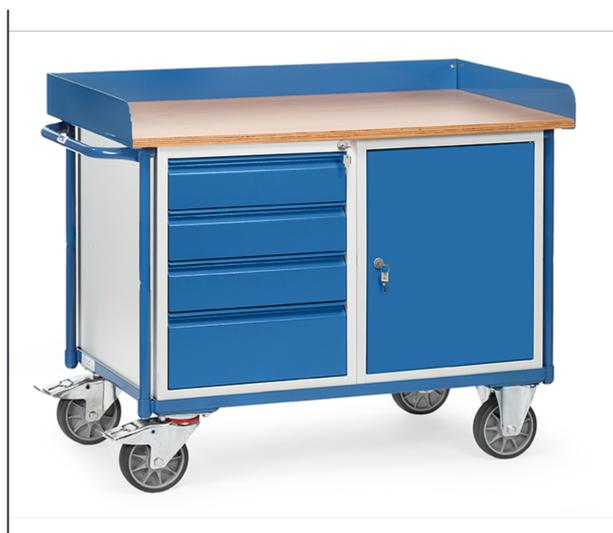
Profilstahl-/Stahlrohrkonstruktion, pulverbeschichtet RAL 5007. Arbeitsplatte aus Buchensperrholz, 22 mm stark. Mit 3-seitiger Umrandung 80 mm hoch. 1 verschließbarer Stahlschrank mit Flügeltür. 1 fester und 2 verstellbare Böden im Stahlschrank. 1 verschließbarer Schubladenschrank. 3 Schubladen 120 mm hoch und 1 Schublade 180 mm hoch. Kugelauszug und Auszugssperre, 4/5 Auszug. Abmessungen Schränke: (B x T x H: 500 x 600 x 600 mm).
