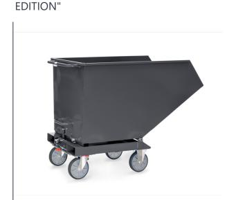
Muldenkipper mit kippbar gelagerter Mulde aus 2 mm starkem Stahlblech, Rand oben zweimal umgekantet, Schüttkante doppelt umgelegt, öldicht verschweißt. Untergestell aus 3 mm starken Kantprofilen mit integrierten Staplertaschen. Trittblech und Kippsicherung, Rohrschiebegriff. Pulverbeschichtung anthrazitgrau RAL 7016. 2 Lenk- und 2 Bockrollen. Räder mit TPE-Bereifung, Naben mit Rillenkugellager.
