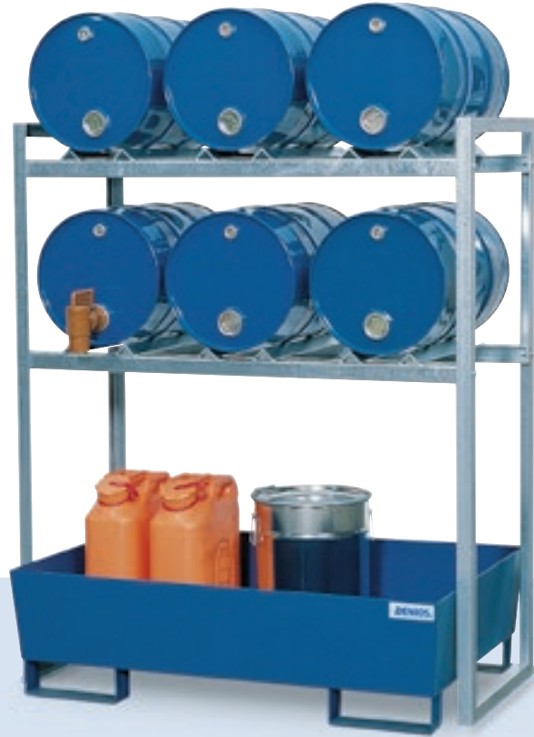
Fassregal Typ FR-S 6-60 mit 2 Ebenen für bis zu 6 Fässer à 60 Liter und Kleingebinde, Auffangwanne aus Stahl (Volumen: 200 Liter) zum direkten Einstellen
