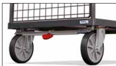
TOTALSTOP - Das fetra-Zentralbremsystem Mit nur einem Fußtritt werden Raddrehung und Schwenkbewegung beider Lenkrollen blockiert. Das Bremspedal bleibt immer im Sichtfeld des Bedieners. Serienmäßig an allen Kastenwagen.
