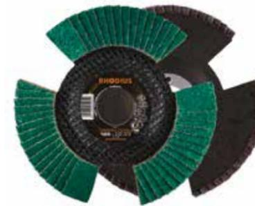
Dank ihrer Aussparungen wird die VISION COOL beim Drehen transparent. Das garantiert freie Sicht auf das Werkstück, der Anwender sieht, wieviel und wo er schleift. So wird eine permanente Kontrolle des Arbeitsergebnisses ohne Absetzen der Maschine erreicht. Der Materialabtrag kann so gezielt gesteuert und kostenintensive Bearbeitungsfehler reduziert werden. Faserstoffträger, Zirkonkorund
