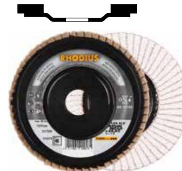
Die ideale Lamellenschleifscheibe für das langlebige Schleifen von Aluminium und anderen schmierenden NE-Metallen, sowie Holz. Die besondere Einkerbung des Trägers versetzt die Scheibe in Schwingung und ermöglicht sanftes Freischlagen. Besonders wichtig bei schmierenden Werkstoffen. Die spezielle Beschichtung des Lamellenbandes unterstützt diesen Effekt zusätzlich.
