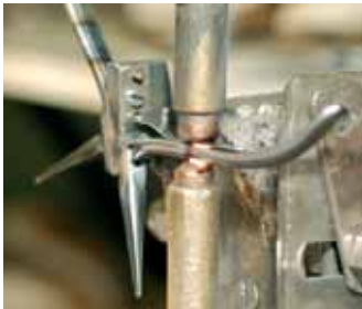
Punktgeschweisste, unverlierbare Federn
