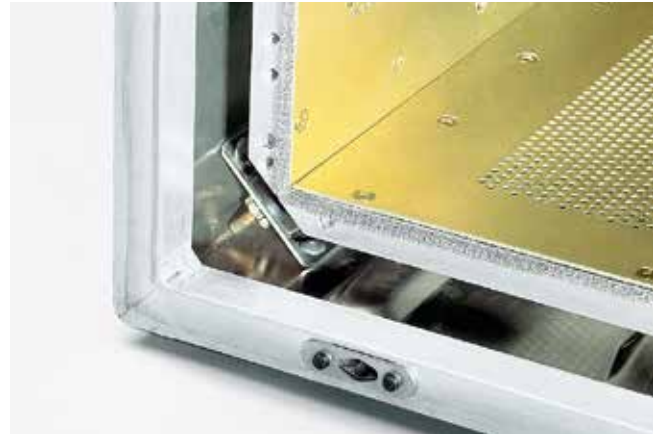
Gehäuse ausgestattet mit chromatierten Lochblechen und HF-Dichtsnur im Schwingrahmen
