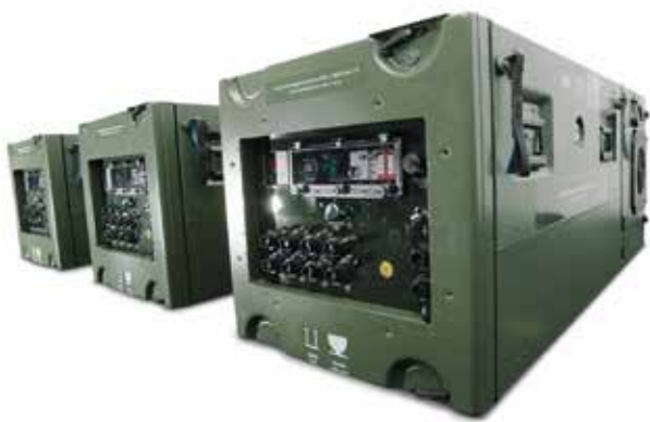
Dezentrale Serversegmente in Mitraset® Classic-Gehäusen mit Klimagerät
