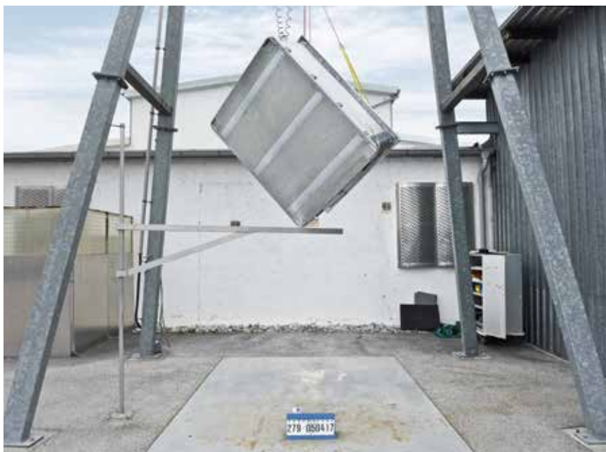
K 473 als Gefahrgutumschließung für Lithiumbatterien bei einer Fallprüfung aus 1,80 m Höhe mit einer Bruttomasse von 500 kg
