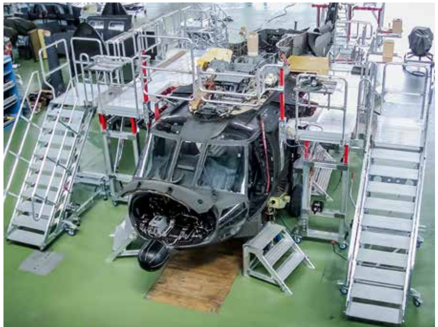
Höhenverstellbare Arbeitsbühnen mit Konturanpassungen für optimale Wartungsarbeiten
