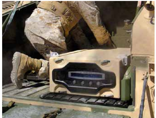
Anti-IED-Elektroniksystem in Mitraset® Classic-Gehäuse mit Spezialverstärkung und Sonderdeckeln im Fahrzeug betrieben
