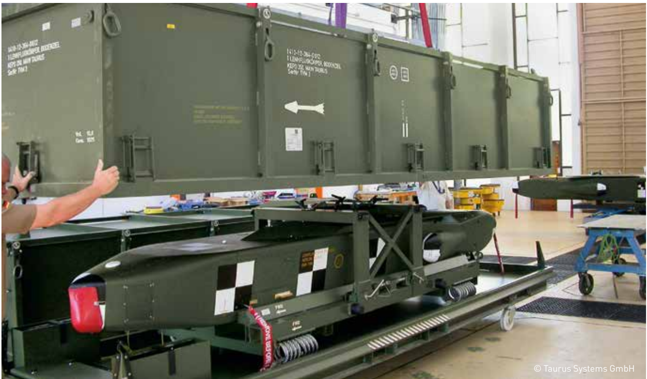
Luftdichter Spezialbehälter für Transport und Lagerung von Flugkörpern
