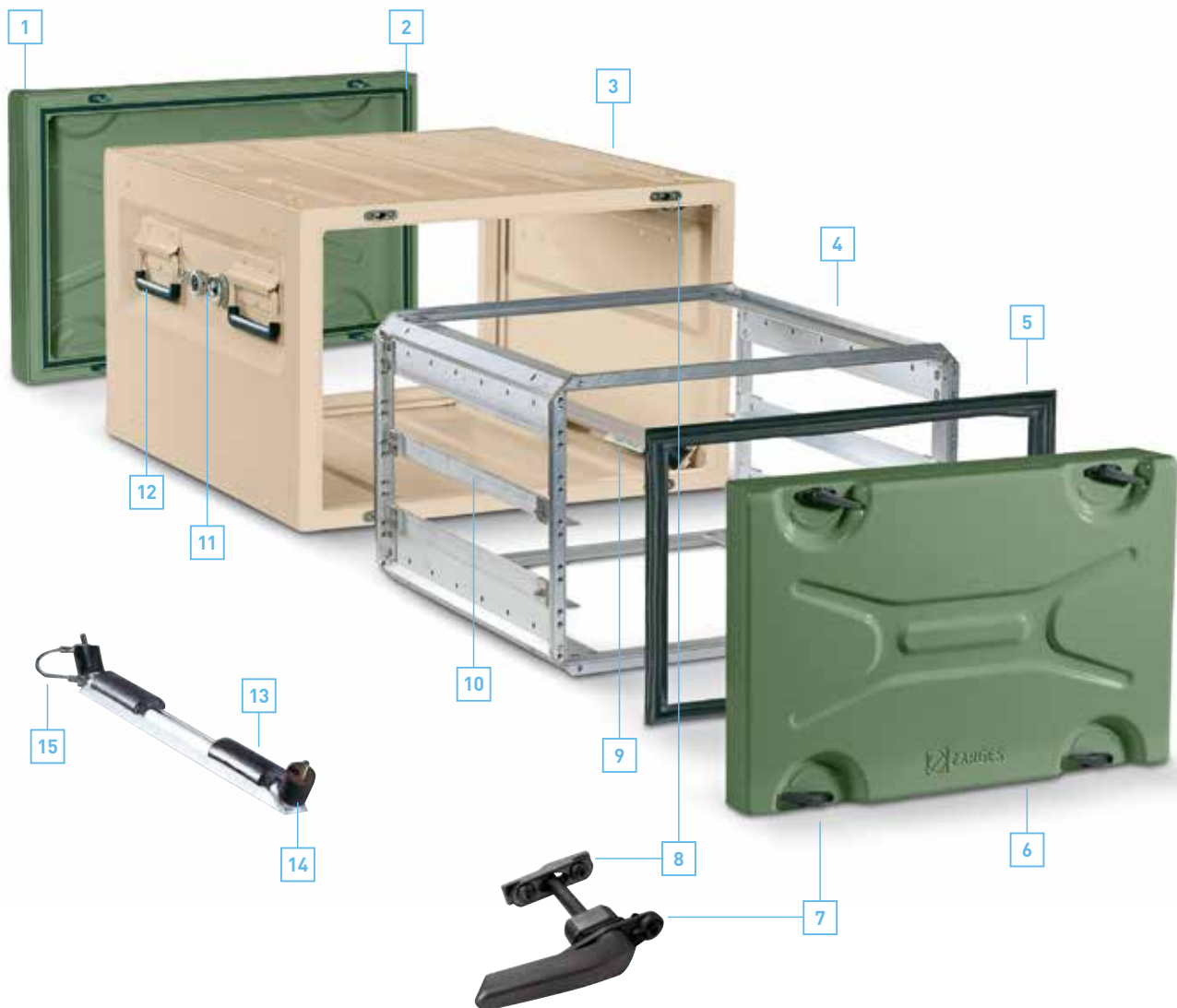
1 Deckel. 2 Gummidichtung. 3 Gehäuse. 4 Schwingrahmen. 5 Dichtmanschette. 6 Deckel. 7 Knebelverschluss. 8 Schwimmende Verschlussaufnahme. 9 Schiene. 10 Führungsschiene. 11 Druckausgleich (3 Varianten). 12 Tragegriff. 13 Anschlagdämpfer. 14 Gummipuffer. 15 Masseband.
