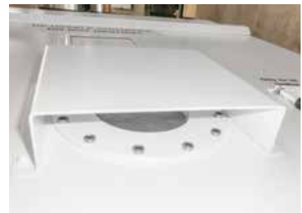
Sicherheitselement Berstscheibe: Schutz bei plötzlichem Druckabfall in der Umgebung
