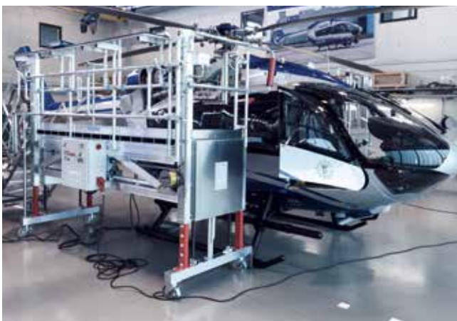
Elektrisch höhenverstellbare und fahrbare Wartungsplattform für den Polizeihubschrauber H145
