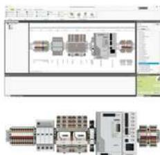
Intuitive Planungs- und Markierungs-Software zur Projektierung von Klemmenleisten und zur professionellen Beschriftung von Markierungsmaterialien für Klemmen, Leiter, Kabel, Geräte und Anlagen. Die Software steht zum Download zur Verfügung
