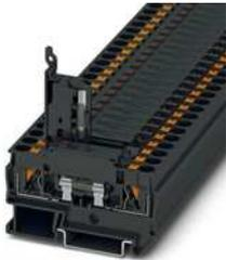
Sicherungsreihenklemme, Art der Sicherung: Glas / Keramik / ..., Sicherungstyp: G / 5 x 20, Nennspannung: 24 V, Nennstrom: 6,3 A, Anschlussart: Push-in-Anschluss, 1. Etage, Bemessungsquerschnitt: 1 mm<sup>2</sup>, Querschnitt: 0,2 mm<sup>2</sup>- 6 mm<sup>2</sup>, Montageart: NS 35/7,5, NS 35/15, Farbe: schwarz
