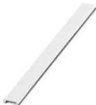
Zackband flach, Streifen, weiß, unbeschriftet, beschriftbar mit: PLOTMARK, CMS-P1-PLOTTER, Montageart: verrasten, für Klemmenbreite: 8 mm, Schriftfeldgröße: 5,15 x 8,15 mm, Anzahl der Einzelschilder: 10
