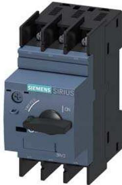
Leistungsschalter Baugröße S0 für den Motorschutz, CLASS 10 A-Auslöser 18...25 A N-Auslöser 325 A Ringkabelschuhanschluss Standardschaltvermögen
