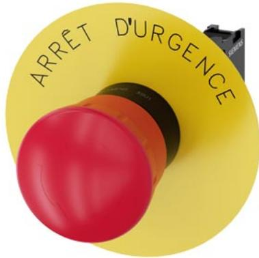
NOT-HALT-Pilzdrucktaster, 22 mm, rund, Kunststoff, rot, 40 mm, zwangsläufige Verrastung, gemäß DIN EN ISO 13850, Drehentriegelung, mit gelbem Unterlegschild, Beschriftung: Arrêt d'urgence, mit Halter, 1Ö, Schraubanschluss
