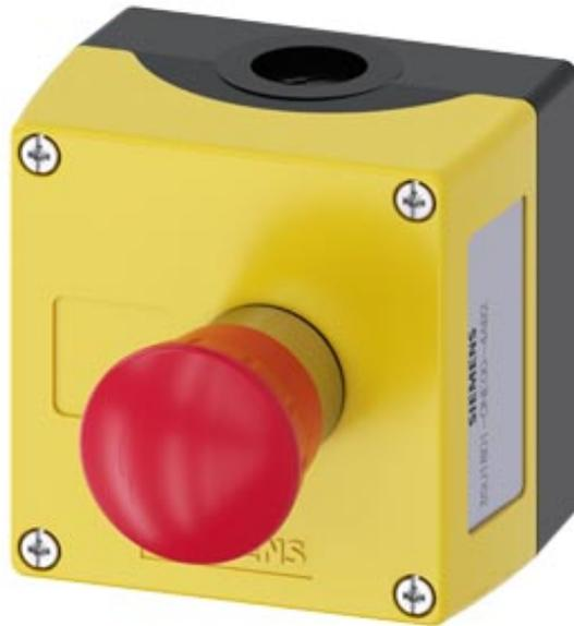
Gehäuse für Befehlsgeräte 22 mm, rund, Gehäusematerial Kunststoff, Gehäuseoberteil gelb, 1 Befehlsstelle, A=NOT-HALT-Pilzdrucktaster rot, Metall, 40 mm, drehentriegelt, 1S, 1Ö, 1Ö, Federzuganschluss, Bodenbefestigung, Stützpunktklemme, ohne Schild, oben und unten je 1xM20
