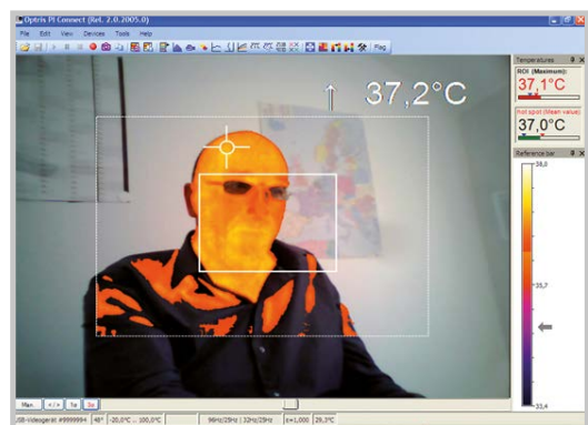
Überblendung des VIS-Bildes oberhalb von 35 °C
