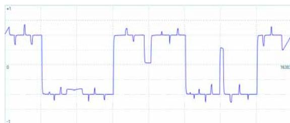
Ebenfalls enthalten ist ein vollständig programmierbarer Generator für anwenderdefinierte Wellenformen mit einem Puffer für bis zu 8000 Abtastungen.
