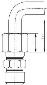
Mindestschenkellänge für gerades Rohrende bei einem Rohrbogen. Das gerade Ende bei Rohrbögen soll bis zu Beginn des Biegeradius mindestens 2x die Höhe der Überwurfmutter betragen.
