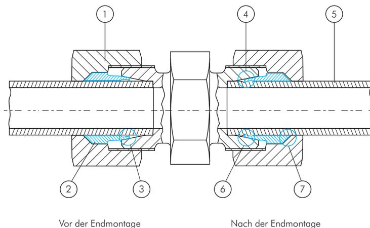
Beim Anziehen presst die Überwurfmutter (1) den Schneidring (2) in den Innenkegel (3) des Verschraubungsstutzens. Hierdurch schneidet die gehärtete Kante (4) des Schneidringes (ungehärtet bei NC-Verschraubungen) in das Rohr (5) ein. Vor der Schneidkante wirft sich das Rohrmaterial zu einem deutlich sichtbaren Wulst (6) auf. Der Schneidring wird gleichzeitig mutternseitig auf dem Rohr verkeilt (7) und bietet so zusätzlichen Halt.
