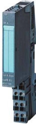
SIMATIC DP, ELEKTRONIKMODUL FUER ET 200S, 1 SSI 25BIT/1MHZ 15MM BAUBREITE MODUL ZUM ANSCHLUSS VON ABSOLUTWERTGEBERN MIT SSI SCHNITTSTELLE SYNCHRON SERIELLES INTERFACE MIT DI UND VERGLEICHSWERT MIT TAKTSYNCHRONITAET
