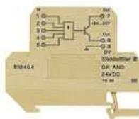
Logik Funktionen AND, NAND, OR und NOR in Reihenklembauform mit einem Nennquerschnitt von 4 mm<sup>2</sup>. Sie verfügen jeweils über 5 Eingänge, die logische verknüpft, auf einen 24 V/ 20 mA PNP Ausgang ausgegeben werden. Die Logik- Bausteine bieten ein breites Applikationsspektrum zur Kopplung digitaler Sensor- / Aktorsignale mit Automatisierungsgeräten.
