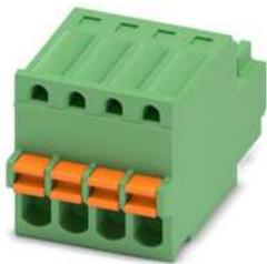
Leiterplattenstecker, Nennquerschnitt: 0,5 mm<sup>2</sup>, Farbe: grün, Nennstrom: 4 A, Bemessungsspannung (III/2): 160 V, Kontaktoberfläche: Zinn, Kontaktart: Buchse, Anzahl der Potenziale: 4, Anzahl der Reihen: 1, Polzahl: 4, Anzahl der Anschlüsse: 4, Artikelfamilie: FK-MC 0,5/..-ST, Rastermaß: 2,5 mm, Anschlussart: Push-in-Federanschluss, Anschlussrichtung Leiter/Platine: 0 °, Stecksystem: COMBICON FK-MC 0,5, Verriegelung: ohne, Befestigungsart: ohne, Verpackungsart: verpackt im Karton
