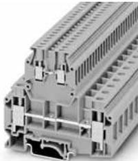
Doppelstockklemme, Nennspannung: 500 V, Nennstrom: 57 A, Anschlussart: Schraubanschluss, 1. Etage, Bemessungsquerschnitt: 10 mm<sup>2</sup>, Querschnitt: 0,5 mm<sup>2</sup> - 16 mm<sup>2</sup>, Anschlussart: Schraubanschluss, 2. Etage, Bemessungsquerschnitt: 2,5 mm<sup>2</sup>, Querschnitt: 0,2 mm<sup>2</sup> - 4 mm<sup>2</sup>, Montageart: NS 35/7,5, NS 35/15, NS 32, Farbe: grau
