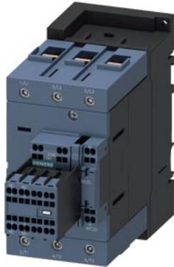
Leistungsschütz, AC-3 95 A, 45 kW / 400 V 2 S + 2 Ö, AC 110 V, 50 Hz 3-polig, 3S, Baugröße S3 Federzuganschluss
